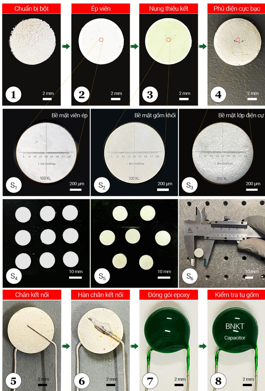
Hình 2.8. Quy trình chế tạo tụ điện gốm điện môi BNKT.
