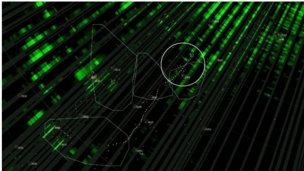
Hình 3-14. Kết quả sau CFAR giai đoạn 2, mục tiêu thử nghiệm trong vòng tròn trắng
