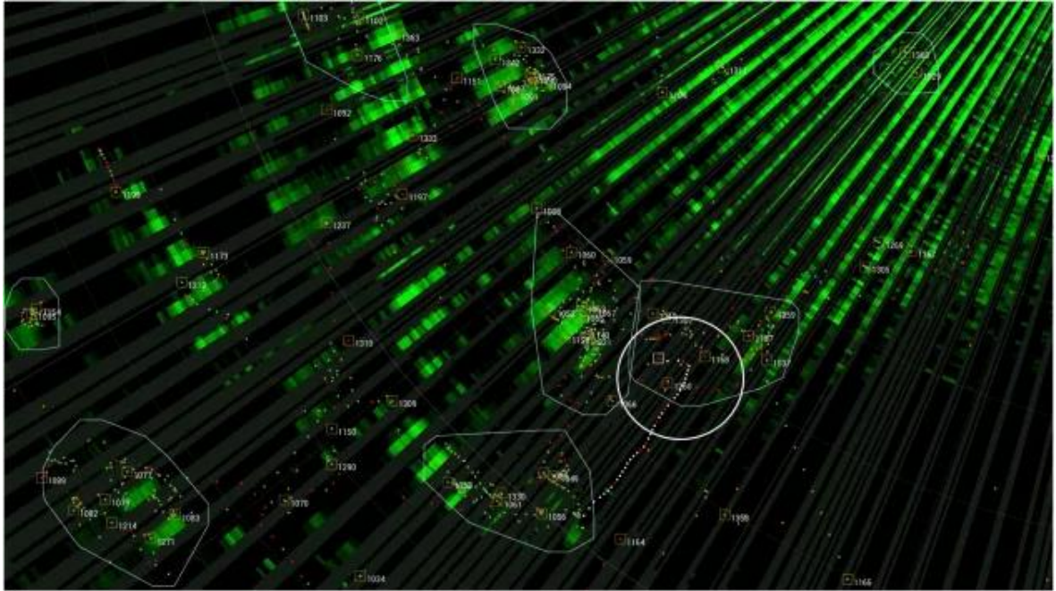
Hình 3-10. Kết quả CFAR giai đoạn 1: mục tiêu thử nghiệm (vòng tròn trắng) và báo động lầm do nhiễu (đa giác)
