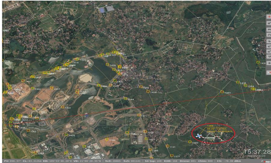
Hình 2-19. Phân loại một chiếc drone (trong hình elip đỏ) ở khoảng cách 3.5 km bằng cách sử dụng 'Street Model'
