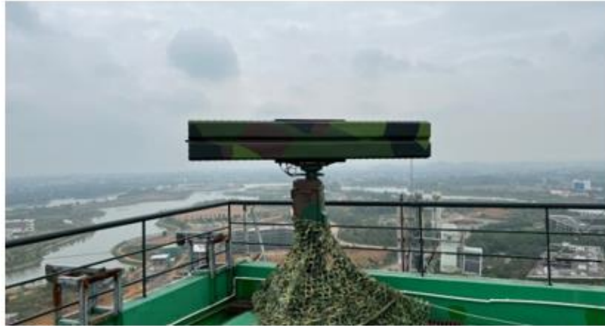
Hình 2-18. Ra-đa FMCW được sử dụng cho nghiên cứu
